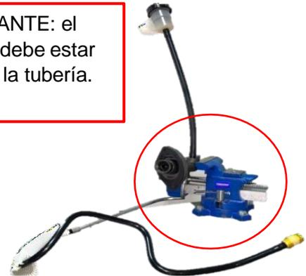
3.- Con el depósito lleno, aplique presión con un desarmador o vástago al Pistón del Cilindro hasta que tenga presión.
